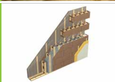
Obr. 42 Skladba steny rámovej konštrukcie zo zložených prierezov – I profilov
