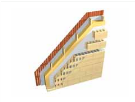
Obr. 39 Skladba steny z kompozitných tvaroviek s vonkajšou prídavnou tepelnou izoláciou v rožtoch
